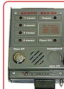
**БСУ (блок сигнализации и управления)** предназначен для адресного автоматического обнаружения аварийного повышения температуры среды в защищаемых отсеках, оповещения водителя о внештатных ситуациях (в т.ч. неисправностях элементов системы пожаротушения), запуска средств пожаротушения в ручном или автоматическом режиме.
