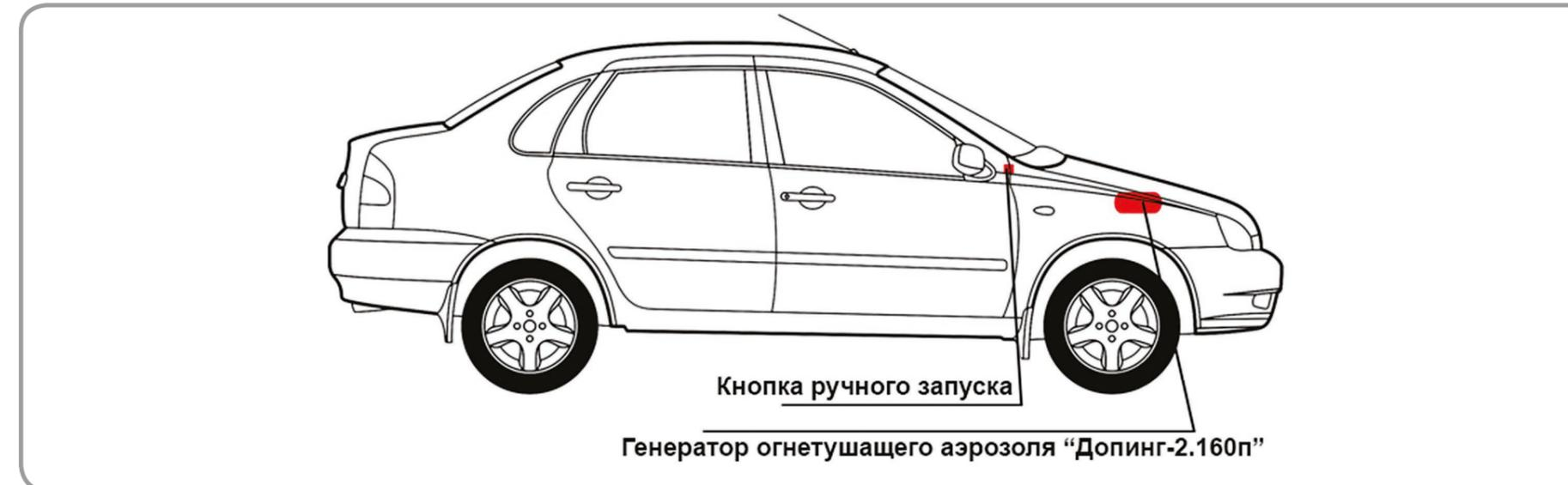
**Кнопка ручного пуска**, установленная в салоне легкового автомобиля. Предназначена для запуска системы пожаротушения в ручном режиме (например, для предотвращения возгорания в двигательном отсеке в результате ДТП).
