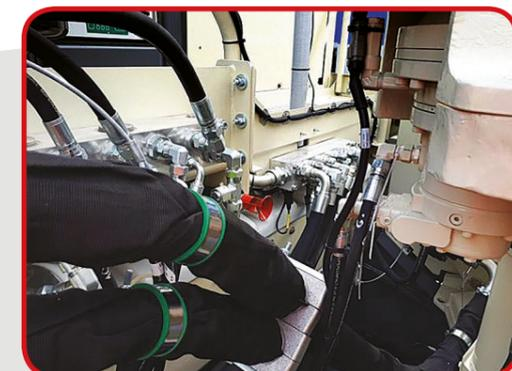
Место установки распылителей пожаротушения в узле распределения гидравлической жидкости
