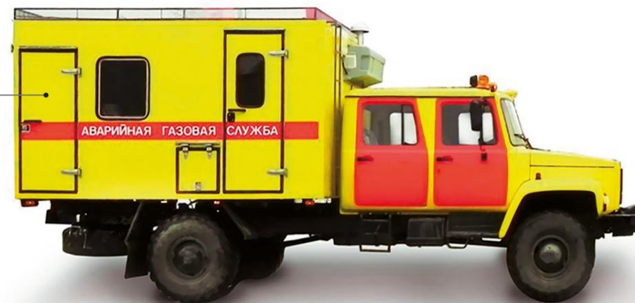
Типовой комплект защиты спецтехники (аварийных машин специальных ремонтных и восстановительных служб) призван обеспечить, в первую очередь, пожарную безопасность отсека со специальным оборудованием (газовый пост, дизельгенератор и т.д.). Также на подобные машины можно установить типовой комплект для грузовых автомобилей, который обеспечивает пожарную безопасность моторного отсека.
