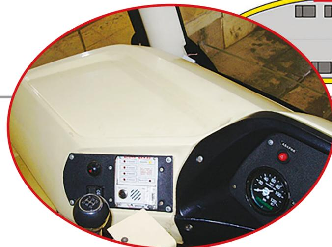
**БСУ (блок сигнализации и управления)** предназначен для адресного автоматического обнаружения аварийного повышения температуры среды в защищаемых отсеках, оповещения водителя о внештатных ситуациях (в т.ч. неисправностях элементов системы пожаротушения), запуска средств пожаротушения в ручном или автоматическом режимах.
