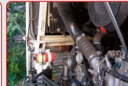
Моторный отсек автобуса с установленными генераторами огнетушащего аэрозоля
