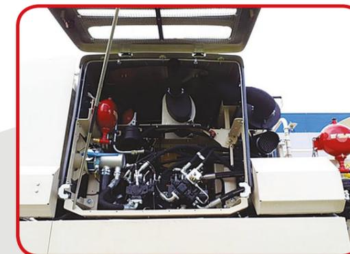
Моторный отсек с установленными модулями порошкового пожаротушения
