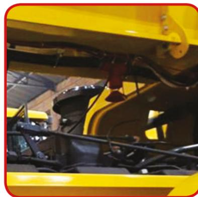
Установленные в подкапотном пространстве температурный датчик и распылитель огнетушащего аэрозоля
