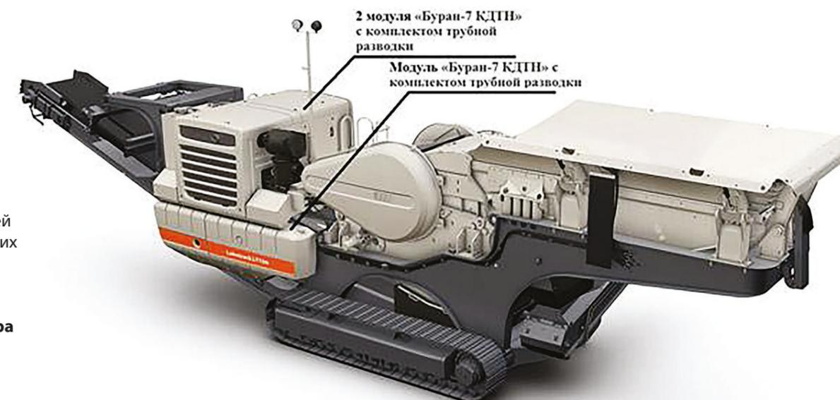
2 модуля «Буря-7 КДП» с комплектом трубной разводки
