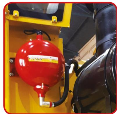
Установленный на правом борту трактора «Кировец» модуль порошкового пожаротушения «**Буря-7КДТ**»
