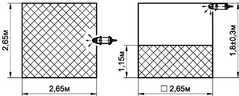
**Конфигурация распыла порошка для модуля
