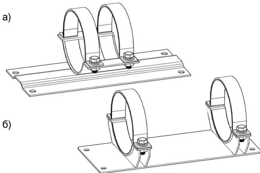
Рисунок 1.1. Комплектация модулей кронштейном в различных исполнениях:
