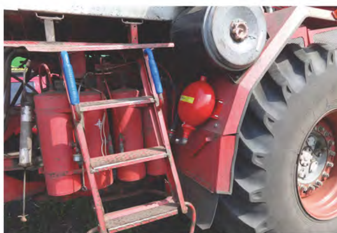
Модуль порошкового пожаротушения «Буран-7КДТН» с трубной разводкой, установленный на трактор К-700
