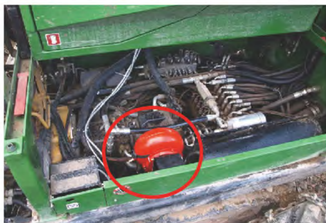
Модуль «Буря-7КДТ», установленный на лесозаготовительной машине
