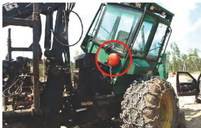
Модуль «Буря-7КДТ», установленный на лесозаготовительной машине
