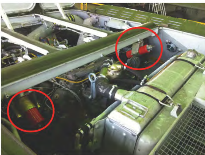
ГОА-19, установленные в моторно-трансмиссионном отделении БТР
