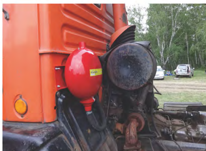
Насадки-распылители системы пожаротушения, установленные на автомобиле КамАЗ
