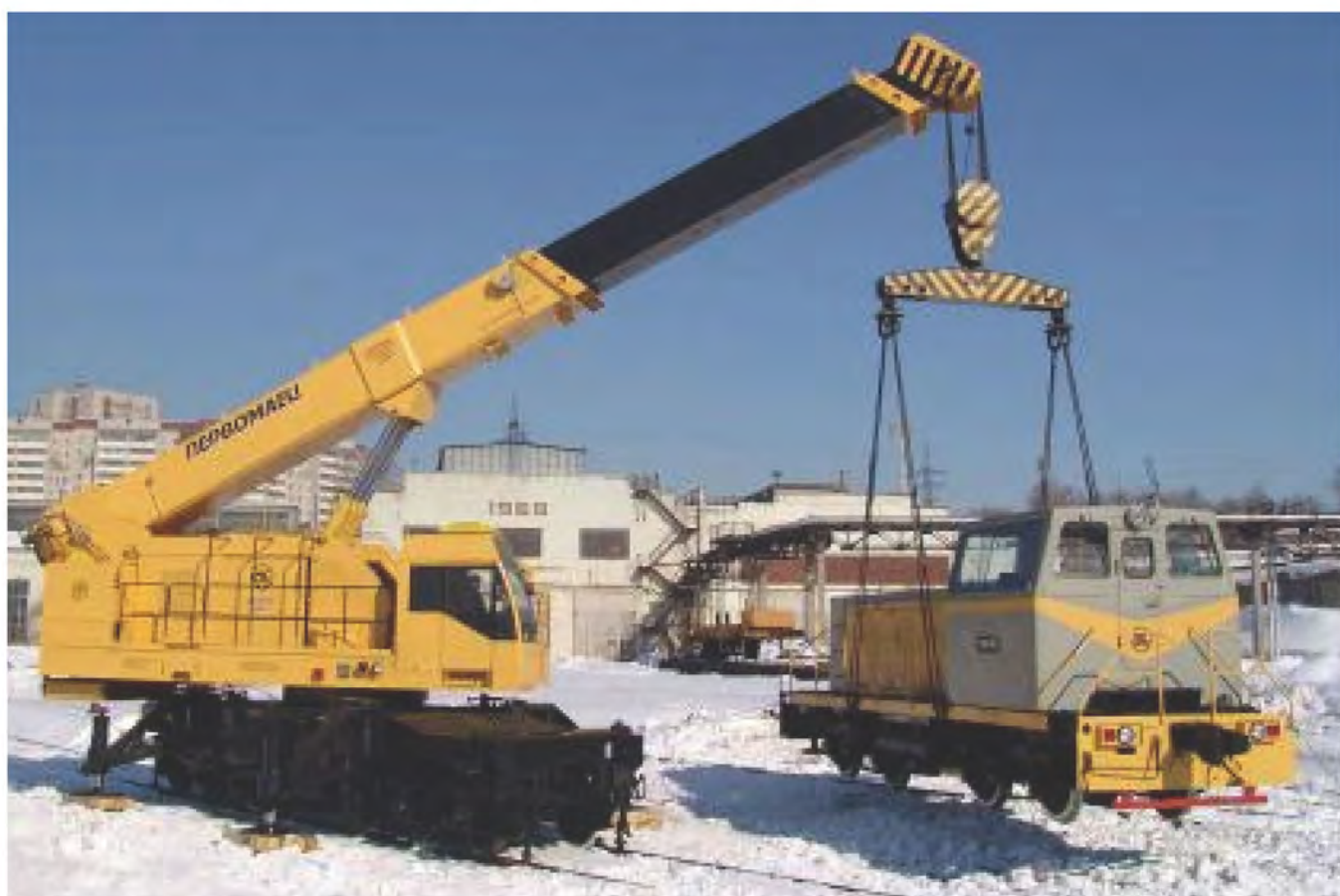
Кран железнодорожный гидравлический КЖ-1572
