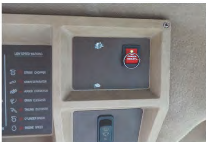
Устройство пуска системы тушения УПСР 24.02, установленное на приборной панели комбайна John Deere
