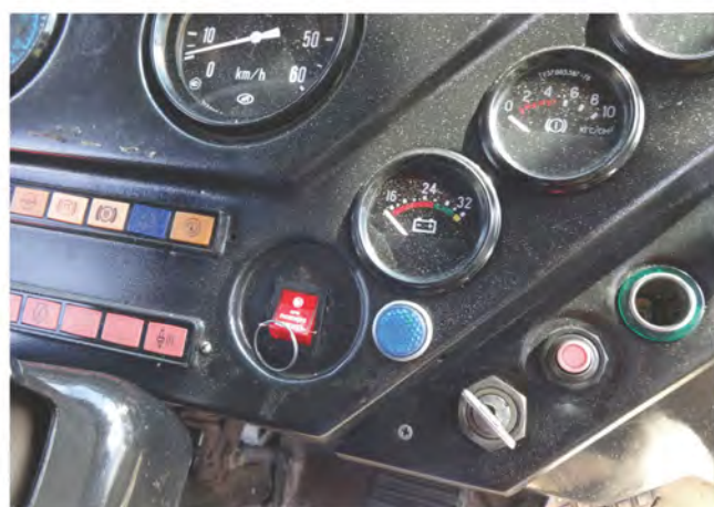
Устройство пуска системы тушения УПСП 24.02, установленное на приборной панели трактора
