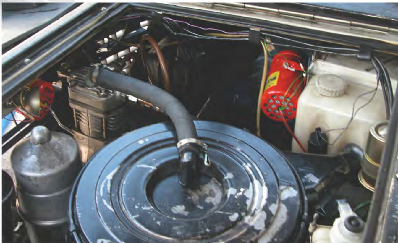
Пример установки ГОА «Допинг» в моторном отделении автобуса «ПАЗ-32053».
