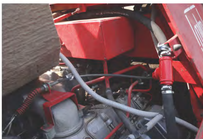
Насадки-распылители, установленные в моторном отсеке трактора К-700 «Кировец»
