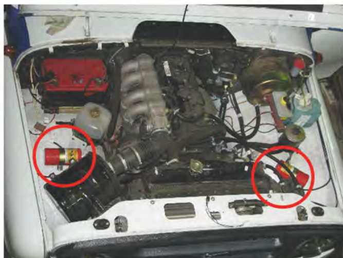
ГОА «Допинг», установленные в моторном отсеке автомобиля УАЗ
