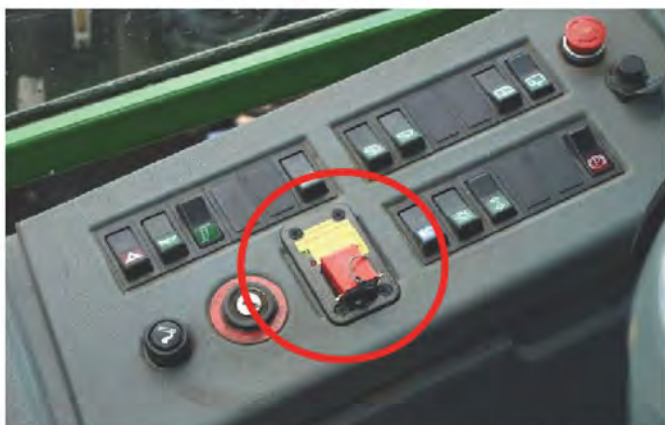
Устройство контроля и пуска средств тушения на транспорте УПСП 12-24.01, установленное на панели в кабине оператора
