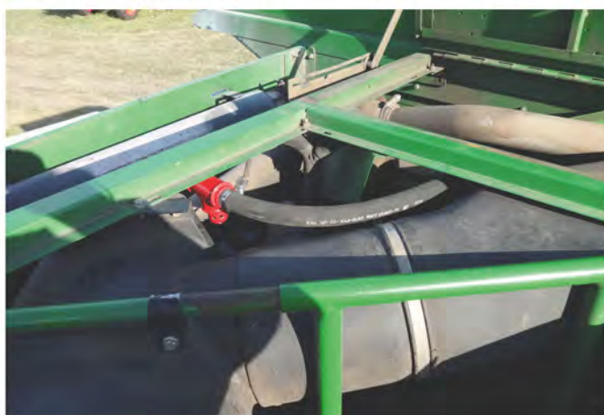
Устройство пуска системы тушения УПСР 24.02, установленное на приборной панели комбайна John Deere
