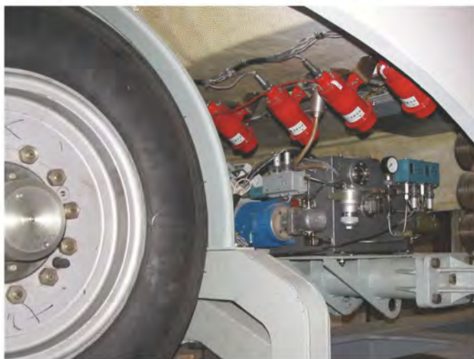
Элементы системы АСОТП «Игла»®, установленные на поездах ММД.
