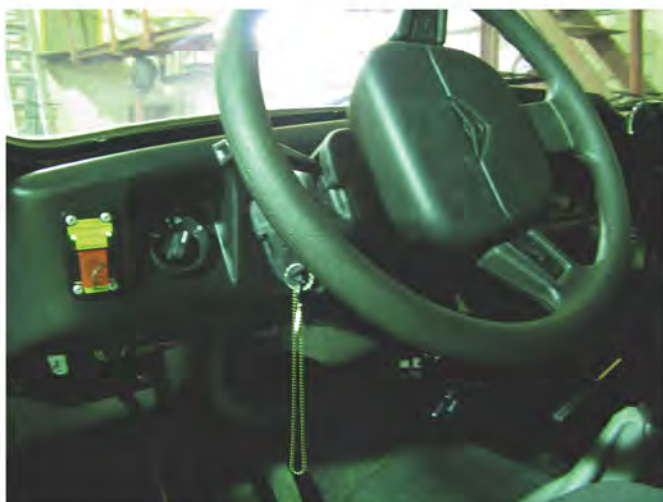
Устройство контроля цепи и пуска УПСП 12-24.01, установленное на приборной панели
