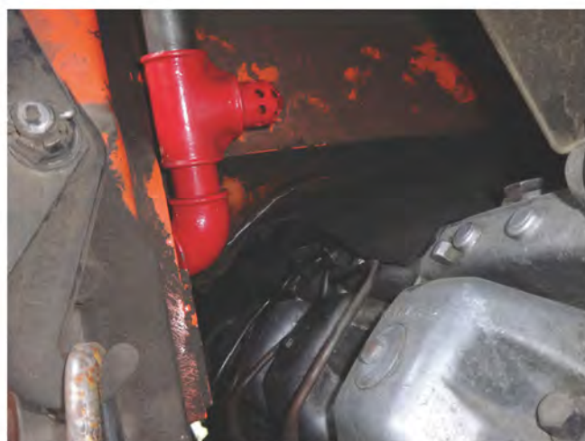
Насадки-распылители системы пожаротушения, установленные на автомобиле КамАЗ
